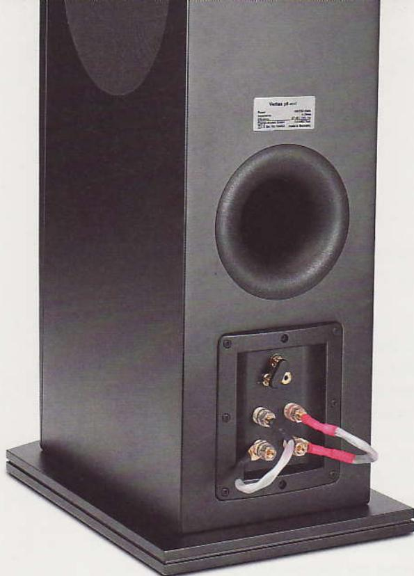
Die hochwertigen Kabelbrücken und die Innenverkabelung stammen von WireWorld. Der Hochtonepegel lässt sich per Jumper an die Umgebung anpassen
