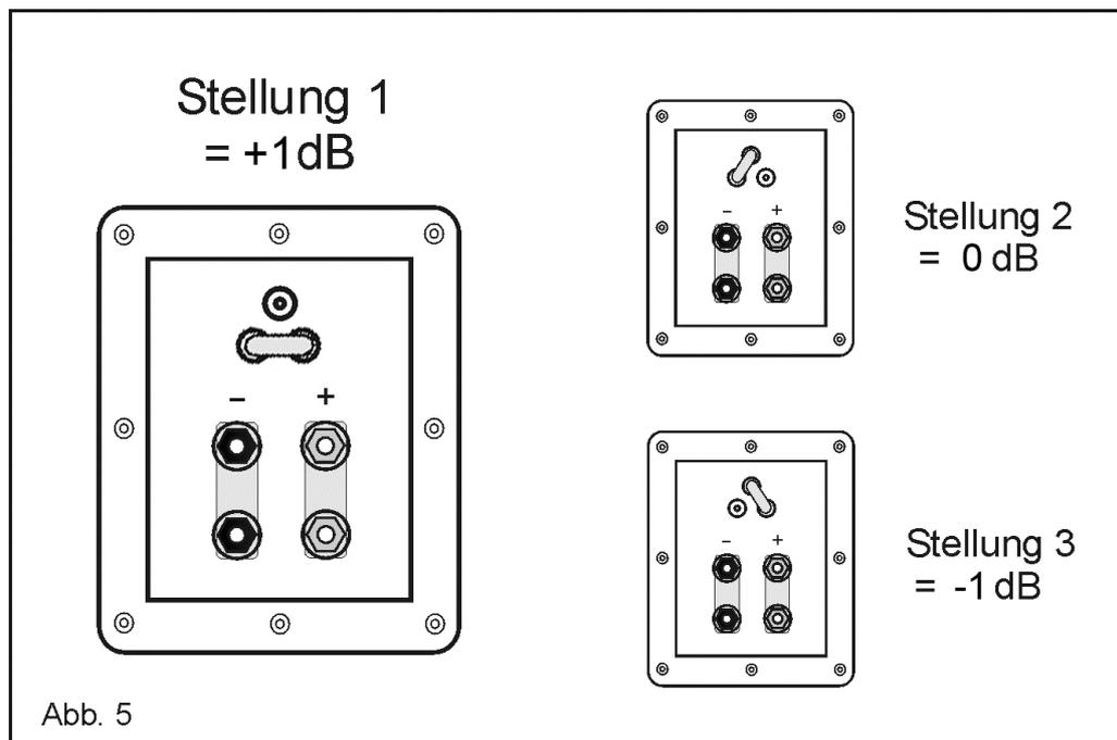
Die Stellung 2 verspricht eine lineare Einstellung des Hochtonpegels. Stellungen 1 und 3 erhöhen bzw. senkt den Pegel um 1dB.
