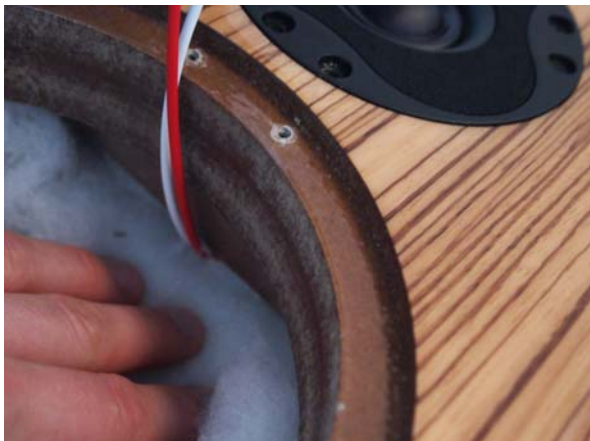
Dickes Ding: Die 38 mm starke Schallwand
