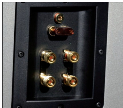
STECKBAR: Der Hochtton wird je nach Stellung des Jumpers etwas abgeschwächt.
