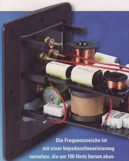
Die Frequenzweiche ist mit einer Impedanzlinearisierung versehen, die um 100 Hertz herum akustisch eingreift und eine Überhöhung verhindert
